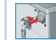
1. Selon le modèle : Raccordez le flexible d'arrivée d'eau (les flexibles) à un robinet d'eau (aux robinets d'eau) 3/4" = 26,4 mm et à l'appareil. **Attention :** Ne serrez les raccords qu'à la main.
