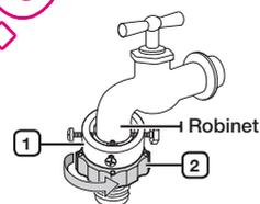
4. Raccordez le tuyau d'arrivée d'eau à l'adaptateur. Lorsque vous lâchez la partie (3), le tuyau se raccorde automatiquement à l'adaptateur en faisant un « clic ».
