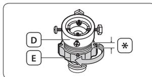
4. Raccordez l'adaptateur au robinet en serrant fermement toutes les vis et en levant l'adaptateur vers le haut.
