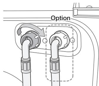
6. Ouvrez l'arrivée d'eau et vérifiez l'absence de fuite au niveau de la vanne d'arrivée d'eau, du robinet ou de l'adaptateur. En cas de fuite d'eau, répétez les étapes précédentes.
