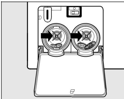
Nettoyez soigneusement les filtres. Vérifiez si la turbine de la pompe de vidange tourne facilement, enlevez les corps étrangers (boutons, pièces de monnaie, etc.) si nécessaire, et nettoyez l'intérieur.
