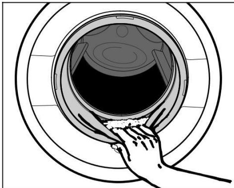
Vérifiez qu'aucun corps étranger n'est resté coincé dans le joint d'étanchéité de la porte.
