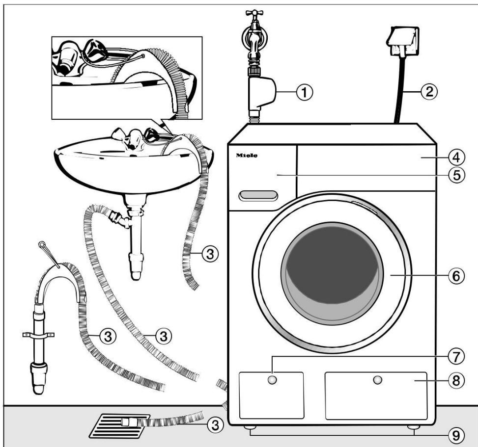
a Tuyau d'arrivée d'eau avec Aquasécurité
