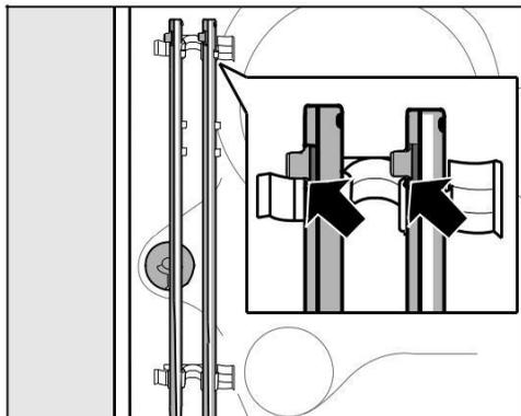
Fixez les tiges de transport au dos du lave-linge. Veillez à ce que l'ergot de verrouillage supérieur se trouve au-dessus de la fixation.
