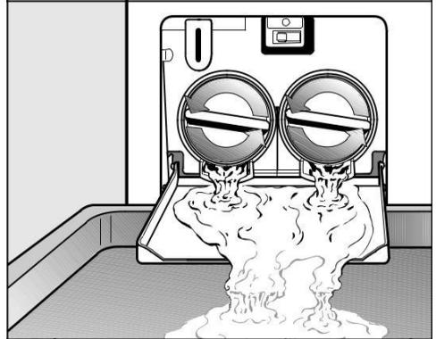
Dévissez lentement les filtres jusqu'à ce que l'eau s'écoule.
