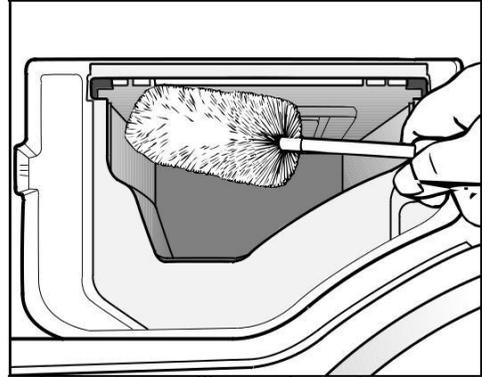
Avec un goupillon, enlevez les restes de produits lessiviels et le dépôt de tartre des buses d'arrivée d'eau du bac à produits.
