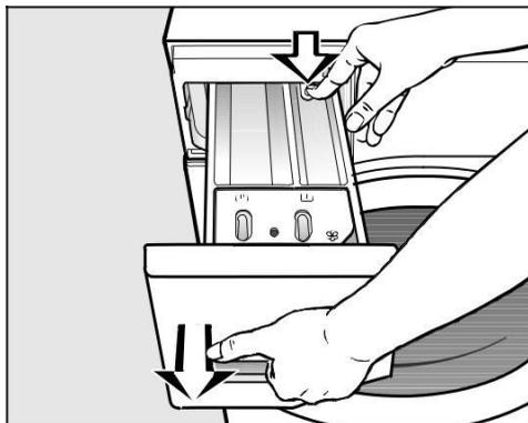
Ouvrez le bac à produits jusqu'à la butée, appuyez sur le bouton de déverrouillage et sortez entièrement le bac à produits.
