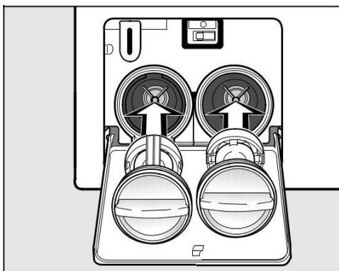
Remettez les filtres à lessive correctement en place (à droite et à gauche) et revissez les bien.
