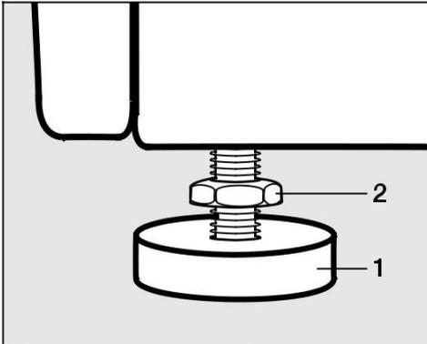
Desserrez le contre-écrou **2** dans le sens des aiguilles d'une montre à l'aide de la clé à fourche fournie. Dévissez le contre-écrou **2** avec le pied **1**.
