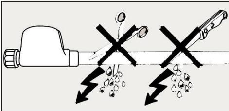
**La gaine de protection ne doit être ni endommagée ni pliée.**
