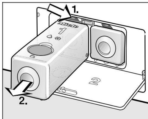
Pressez le bouton de déverrouillage jaune (1.) et sortez le réservoir (2.).
