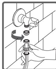
**L'appareil doit être raccordé au réseau de distribution d'eau en utilisant les ensembles de raccordement neufs fournis avec l'appareil, il convient de ne pas réutiliser des ensembles de raccordement usagés.**
