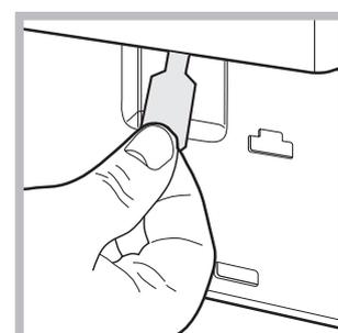
4. se servir de la languette indiquée, tirer vers soi jusqu'à ce que le tirant en plastique se dégage de son cran d'arrêt; tirer ensuite vers le bas et ouvrir la porte en même temps.
