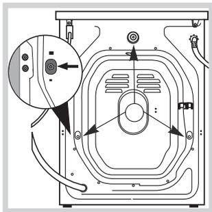
3. Enlever les **3** vis de protection servant au transport, le caoutchouc et la cale, placés dans la partie arrière (voir figure).
