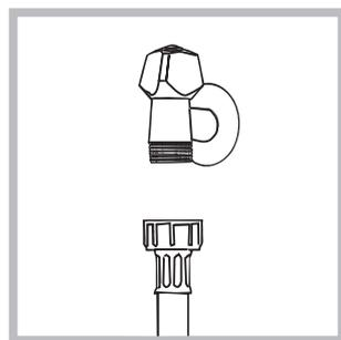
2. Reliez le tuyau d'alimentation en le vissant à un robinet d'eau froide à embout fileté 3/4 gaz (voir figure).
