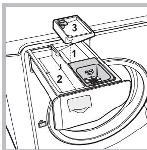
plus résistantes. Possibilité d'utilisation avec ou sans eau de Javel. Pour effectuer un blanchiment aussi, il faut introduire le bac supplémentaire 3, fourni, dans le bac 1. Au moment de verser l'eau de Javel, attention à ne pas dépasser le niveau "max" indiqué sur le pivot central (voir figure).
