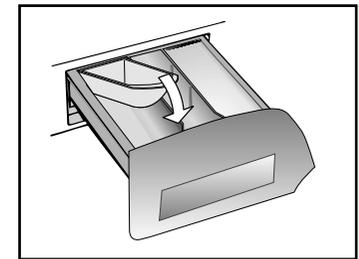
Ce bac doit être introduit dans la section "2" du tiroir à lessive, également lorsque l'on désire utiliser le programme "RINÇAGES" comme cycle de BLANCHISSAGE.
