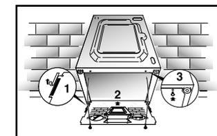
a) Tourner dans le sens des aiguilles d'une montre l'écrou de façon à déverrouiller la vis du pied.
