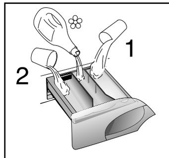
Si vous souhaitez utiliser une lessive liquide, un récipient spécial peut être inséré dans la section “2” du tiroir à lessive. Grâce à ce système, la lessive s’écoulera dans le tambour seulement au bon moment.
