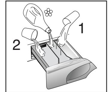
Si vous souhaitez utiliser une lessive liquide, un récipient spécial peut être inséré dans la section "2" du tiroir à lessive. Grâce à ce système, la lessive s'écoulera dans le tambour seulement au bon moment.
