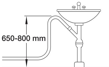
Vous pouvez connecter le tuyau d'évacuation directement à une conduite existante (sous le lavabo ou l'évier, par exemple) en amont du siphon. Disposez le tuyau de vidange de façon à ce qu'une portion de sa longueur soit acheminée à un niveau correspondant au bord supérieur du lavabo et soit fixée à cet endroit.
