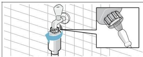
6. Nettoyez du filtre à l'arrière de l'appareil sur les modèles Standard et Aqua-Secure : Retirez le flexible au dos de l'appareil, Extrayez le filtre avec une pince et nettoyez-le.
