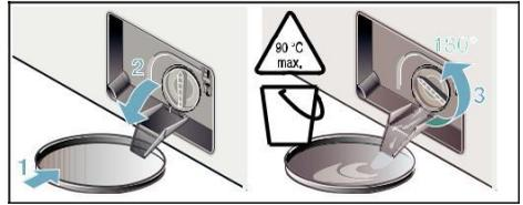
6. Dévissez maintenant prudemment le couvercle de pompe. L'eau résiduelle risque de couler. Nettoyez le compartiment intérieur, le filetage du couvercle de pompe et le carter de pompe. Le rotor de la pompe de vidange doit pouvoir tourner librement. Remettez le couvercle en place et vissez-le. Il faut que la poignée se trouve à la verticale.
