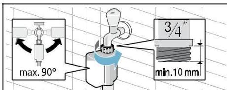
**Remarque :** Ouvrez prudemment le robinet d'eau tout en vérifiant si les raccords sont étanches. La jonction par vis se trouve sous la pression régnant dans la conduite d'eau.
