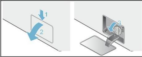
5. – Retirez le **tuyau de vidange** de la fixation et retirez le capuchon de fermeture. Laissez le bain lessiviel s'écouler dans un récipient approprié. Enfoncez le capuchon de fermeture du tuyau de vidange et remettez le tuyau de vidange dans la fixation.
