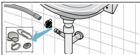
4. Remmanchez le flexible d'écoulement et sécurisez le point de raccordement à l'aide du collier du flexible.
