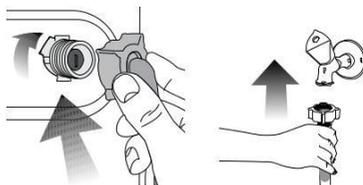
3. Ouvrez les robinets complètement après avoir raccordé les tuyaux pour vérifier si de l'eau ne fuit pas par les points de raccordement. Si vous constatez des fuites, fermez le robinet et retirez l'écrou. Resserrez l'écrou soigneusement après avoir vérifié le joint. Pour éviter toute fuite d'eau ou dégât consécutif, laissez les robinets fermés lorsque la machine n'est pas utilisée.
