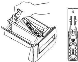
**C** Soulevez la partie arrière du siphon pour le retirer comme sur l'illustration. Après avoir effectué les opérations de nettoyage indiquées, remettez le siphon à son emplacement et poussez la partie avant vers le bas pour vous assurer que la patte de verrouillage s'enclenche.
