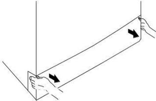
**C** Vous pouvez retirer le couvercle du filtre en poussant légèrement vers le bas à l'aide d'un mince objet pointu en plastic, par la fente située au-dessus du couvercle du filtre. Evitez d'utiliser des objets métalliques pointus pour enlever le couvercle.
