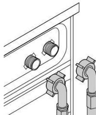
**A**vertissement: Assurez-vous que les raccords d'eau froide et d'eau chaude sont effectués correctement lors de l'installation de votre machine. Sinon, votre linge pourrait être chaud en fin de lavage et s'user.
