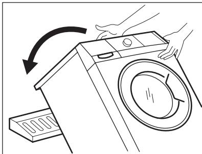
6. Placez l'une des cales en polystyrène au sol derrière l'appareil. Couchez avec soin l'appareil sur le dos. Assurez-vous de ne pas endommager les tuyaux.
