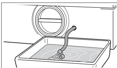
4. Retire a mangueira de escoamento de emergência (B), coloque-a no recipiente e retire a tampa.
