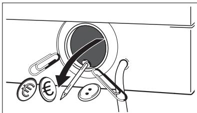
6. Retirez les corps étrangers et les peluches du logement du filtre et de la turbine de la pompe.
