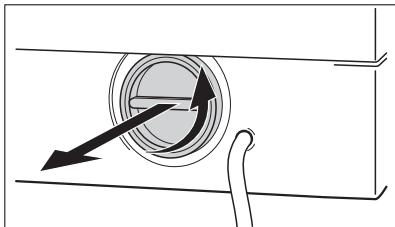
5. Lorsque l'eau cesse de s'écouler, dévissez le couvercle de la pompe (**A**) en le tournant vers la gauche et retirez le filtre. Utilisez une pince si nécessaire.
