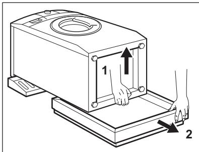
7. Retirez la base en polystyrène en bas de l'appareil.
