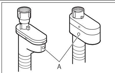
Le tuyau d'alimentation est équipé d'un dispositif de protection contre les dégâts des eaux. Si le tuyau inférieur devait se détériorer à cause d'une usure naturelle, ce dispositif bloquera l'arrivée d'eau à l'appareil. Ce défaut est signalé par l'apparition d'un secteur rouge dans la fenêtre « A ».
