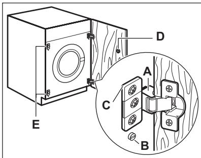
Si la porte doit être ouverte de gauche à droite, inversez la position des plaques **E**, de l'aimant **D** et de la plaque **C**. Montez le contre-aimant **D** et les charnières **A** comme décrit plus haut (Fig. 7).
