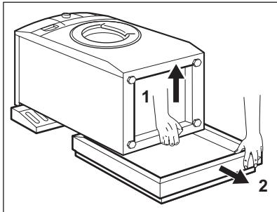
7. Retire a protecção de polistireno da parte inferior.
