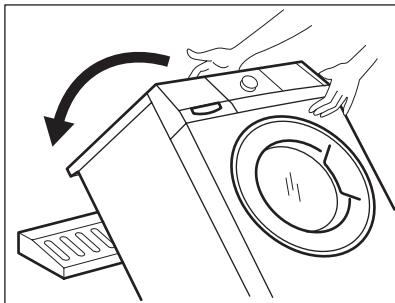
6. Coloque um dos elementos da embalagem de polistireno no chão, atrás do aparelho. Coloque o aparelho com cuidado no chão, com a parte de trás. Certifique-se de que não danifica as mangueiras.
