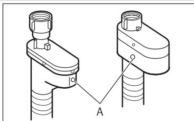
A mangueira de entrada tem um dispositivo de bloqueio da passagem de água. Este dispositivo impede fugas de água na mangueira causadas pelo desgaste natural do tubo. Esta avaria é indicada no sector vermelho da janela «A». Se isto acontecer, feche a torneira de água e contacte o centro de assistência para substituir a mangueira.
