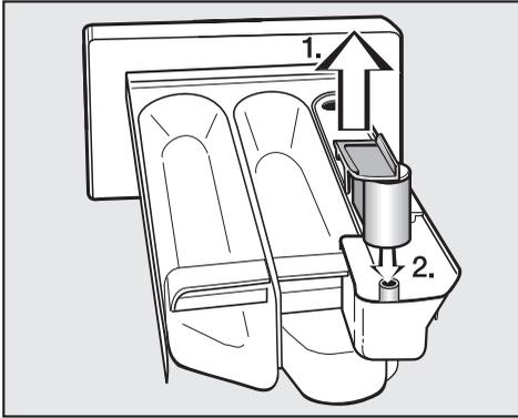
1. Sortez le tube d'aspiration du compartiment ☒ et nettoyez-le à l'eau chaude. Nettoyez également le tuyau sur lequel le tube d'aspiration est fixé.
