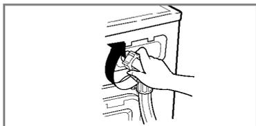
4. Resserrer le tuyau d'arrivée d'eau.
