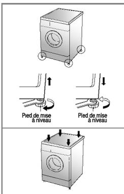
1. Pour réduire les vibrations et les bruits excessifs, installer la machine sur un sol stable et à niveau, de préférence dans un coin de la pièce.
