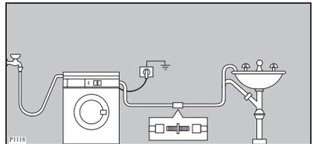
Le tuyau de vidange peut être allongé jusqu'à 4 mètres maximum. Un tuyau de vidange supplémentaire et un raccord sont disponibles auprès de votre service après-vente le plus proche.
