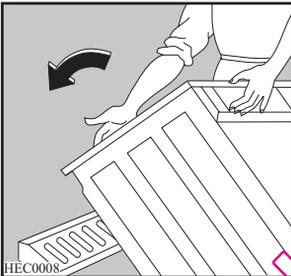
2. Redressez l'appareil et retirez la fixation du câble d'alimentation électriques et du tuyau de vidange de leur support placé à l'arrière de l'appareil.
