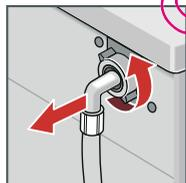
Retirez le flexible au dos de l'appareil.
