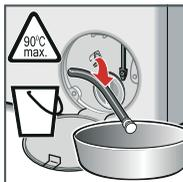
4. Retirez la coiffe d'obturation, laissez le bain lessiviel s'écouler dans un récipient adéquat. Enfoncez la coiffe obturatrice et mettez le flexible de vidange en place dans la fixation.
