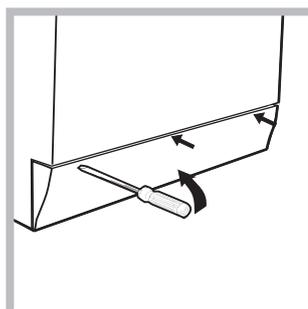
1. rimuovere il pannello di copertura sul lato anteriore della lavabiancheria con l'ausilio di un giravite (vedi figura);
