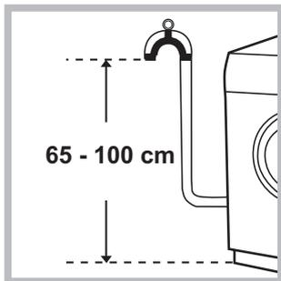
Collegare il tubo di scarico, senza piegarlo, a una conduttura di scarico o a uno scarico a muro posti tra 65 e 100 cm da terra;
