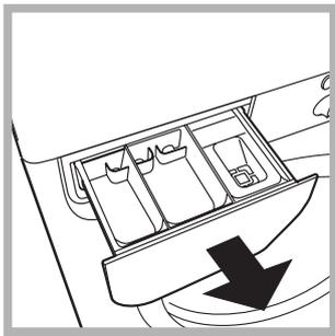
Extraiga el contenedor levantándolo y tirándolo hacia fuera (ver la figura). Lávelo debajo del agua corriente, esta limpieza se debe realizar frecuentemente.
