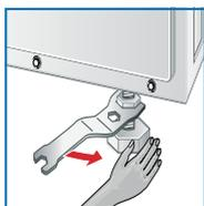
3. Serrez le contre-écrou contre la carrosserie de l'appareil. Ce faisant, maintenez le pied et veillez à ce que sa hauteur ne change pas.
