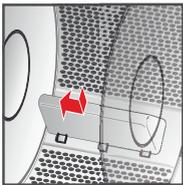
8. Fermez les volets du tambour et faites tourner le tambour d'un demi-tour. Vérifiez la position et la fixation de la pièce en plastique.
