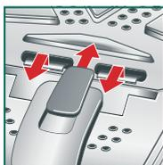
4. Pour fermer le tambour, amenez les deux volets au niveau de l'ouverture du lave-linge, rabattez le volet arrière sur le volet avant puis enfoncez-les tous les deux légèrement pour enclencher le mécanisme de fermeture.
