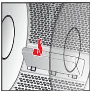
4. À l'aide d'un tournevis, appuyez sur l'élément en plastique situé le plus en bout tout en poussant la pièce en plastique de gauche à droite ; la pièce tombe dans le tambour.
