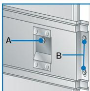
1. Enlevez les deux vis « A » et les quatre vis « B » avec un tournevis plat ou une clé de 8.
