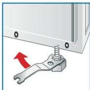
1. Desserrez le contre-écrou à l'aide d'une clé dans le sens de la flèche.
