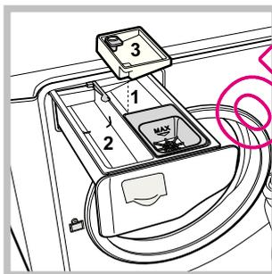
Grâce à l'utilisation d'une plus grande quantité d'eau au cours de la phase initiale du cycle et à une durée prolongée, cette option permet d'obtenir un lavage très performant, est très utile pour éliminer les taches les plus résistantes. Possibilité d'utilisation **avec** ou **sans** eau de Javel. Pour effectuer un blanchiment aussi, il faut introduire le bac supplémentaire 3, fourni, dans le bac 1. Au
