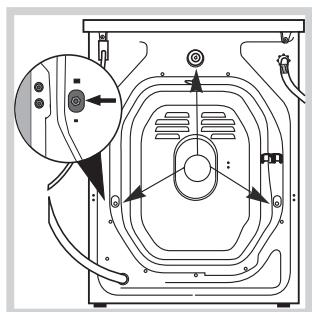
3. Die **3** Transportschutzschrauben herausschrauben und die an der Geräterückwand befindlichen Distanzstücke aus Gummi entfernen (siehe Abbildung).
