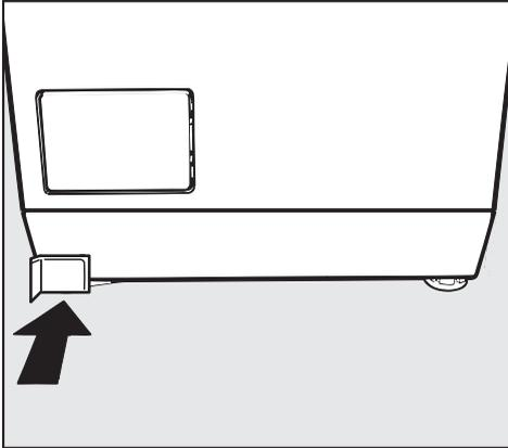
Le levier du châssis à roulettes doit impérativement être positionné sur la gauche pour que le lave-linge soit parfaitement stable.
