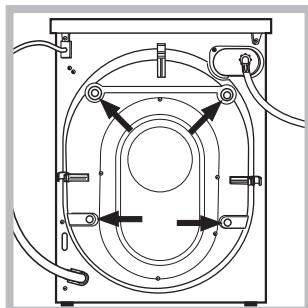
2. Verwijder de 4 beschermsschroeven voor het transport en de bijbehorende afstandsleider die zich aan de achterkant bevinden (zie afbeelding).
