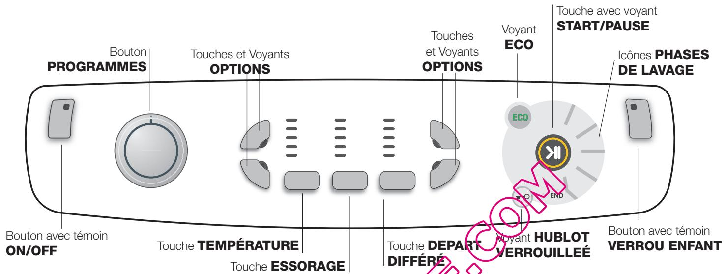
Bouton avec témoin **ON/OFF**: appuyer brièvement sur la touche pour allumer ou éteindre l'appareil. Le témoin vert indique que l'appareil est sous tension. Pour éteindre le lave-linge en cours de lavage, appuyer sur la touche pendant au moins 3 secondes de suite; une pression brève ou accidentelle n'entraîne pas l'arrêt de l'appareil. L'arrêt de l'appareil pendant un lavage annule le lavage en cours.
