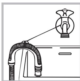
Em alternativa, coloque na beira de um lavabo ou de uma banheira, prendendo na torneira a guia fornecida com o produto (veja a figura). A ponta solta do tubo de descarga não deve permanecer emergida na água.
