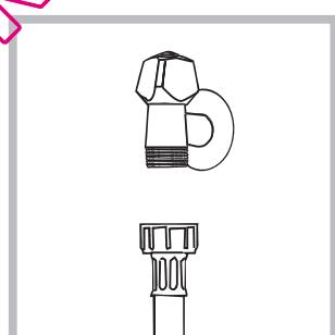
2. Schrauben Sie den Wasserschlauch an einen Kaltwasserhahn mit ¾-GAS-Gewindeanschluss an (siehe Abb.).
