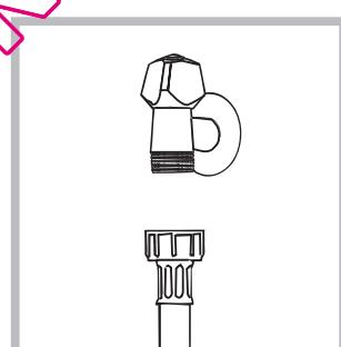
2. Sluit de toeverbuis aan op de koudwaterkraan met een mondstuk met schroefdraad van 3/4 gas (zie afbeelding). Voordat u de wasautomaat aansluit moet u het water laten lopen totdat het helder is.
