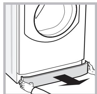
1. remova o painel de cobertura no lado anterior da máquina empurrando para o centro, em seguida empurre para baixo de ambos os lados e remova-o (veja as figuras).
