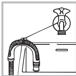
Autrement, accrocher le tuyau de vidange à un évier ou à une baignoire, dans ce cas, fixer le support plastique fourni avec l'appareil au robinet (*voir figure*). L'extrémité libre du tuyau d'évacuation ne doit pas être plongée dans l'eau.
