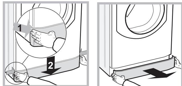
1. Nehmen Sie die Abdeckung an der Gerätefront ab, indem Sie zur Mitte hin drücken, dann drücken Sie beide Seiten nach unten und ziehen sie heraus (siehe Abbildungen).
