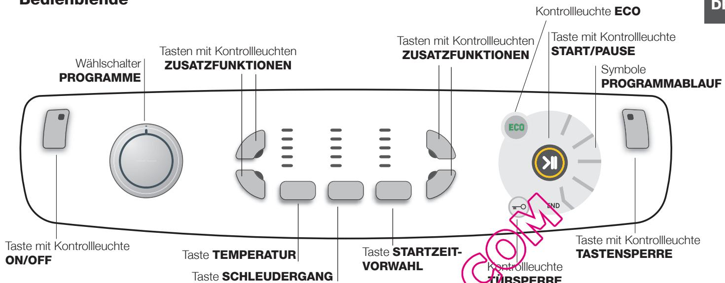
**Taste mit Kontrollleuchte ⚡ ON/OFF:** Drücken Sie kurz auf die Taste, um das Gerät ein- bzw. auszuschalten. Die grüne Kontrollleuchte zeigt an, dass das Gerät eingeschaltet ist. Um den Waschvollautomaten während eines Waschganges auszuschalten, muss die Taste etwas länger gedrückt werden (ca. 3 Sekunden); ein kurzer oder ein ungewöllter Druck bewirkt kein Ausschalten des Gerätes. Das Ausschalten des Gerätes während eines laufenden Waschprogramms löscht den gesamten Waschzyklus.
