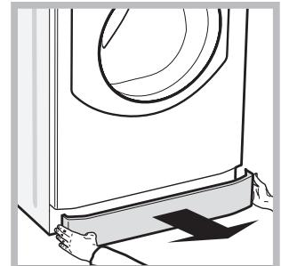
1. verwijder het afdekpaneel aan de voorzijde van de wasautomaat door er op het midden op te drukken. Duw beide zijkanten naar beneden toe en verwijder het paneel (zie afbeeldingen).
