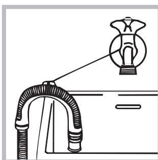
oder hängen Sie ihn in ein Becken oder eine Wanne ein; befestigen Sie ihn in diesem Falle mittels der mitgelieferten Führung an dem Wasserhahn (siehe Abbildung).
