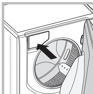
Der Waschmittelbehälter befindet sich im Innern des Gerätes, um ihn zu erreichen, muss die Gerätetür geöffnet werden.
