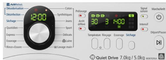
Le système Easy Logic est un bouton rotatif qui permet de contrôler l'ensemble des programmes de la lavante-séchante. Pour chaque type de linge sont prédefinis : la température, le nombre de rinçages et de séchages, la vitesse d'essorage et de séchage. L'utilisateur peut à tout moment modifier les paramètres en fonction des résultats.
